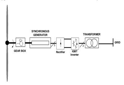
(d) Type 4 Wind Turbine-Generator: Full Power Conversion
